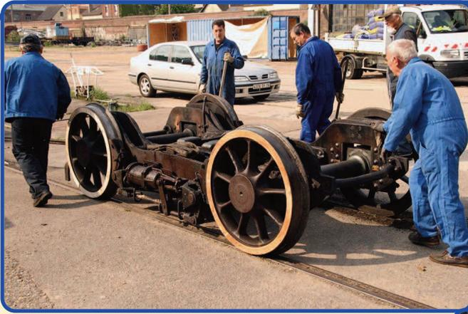
de tôlerie sur le tender, la dépose des 2 autres essieux moteurs qui révèlent une importante usure des quatre coussinets qui vont être refaits. A cela s'ajoute le démontage intégral de la suspension. Tout y passe : les joints d'autoclaves, le démontage des tubes surchauffeurs, la remise en état du collecteur, des vannes de prise vapeur, de la commande de l'injecteur, de la pompe à eau et de la prise d'eau, sans oublier la vérification des circuits de graissage.
